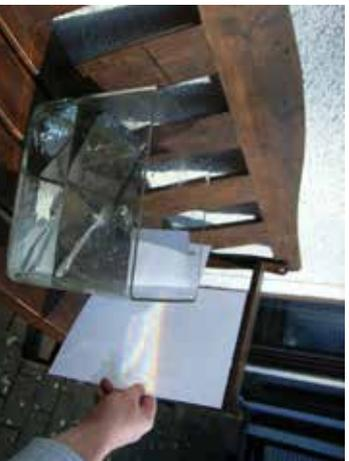
Stelle ein großes Glasgefäß in das Sonnenlicht. Fülle es mit Wasser und lege einen Spiegel so schräg hinein, dass das Licht auf eine weiße Fläche fällt.
